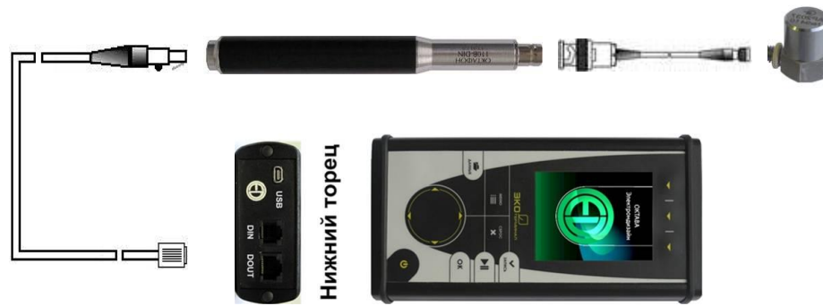
Рис.2. Подключение ОКТАФОН-110В с датчиком АР37 к ИБ ЭКОФИЗИКА-Д
